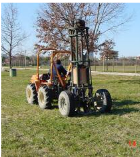
Fig. 7 – Apparato energizzatore semovente a massa battente da 10.000 kg/m.
