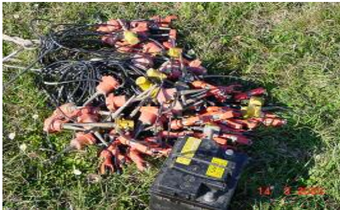
Fig. 8 – Gruppi da 6 geofoni da 30 Hz utilizzati come apparati riceventi.
