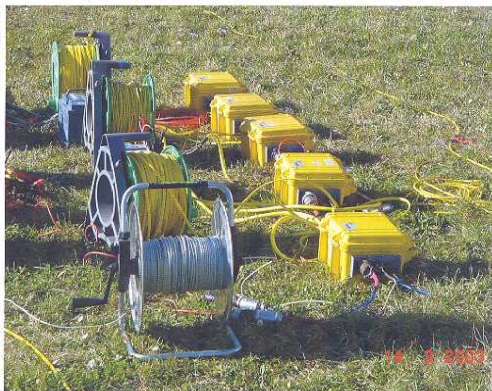
Fig. 2 - Sistema elettronico modulare a 120 canali.
