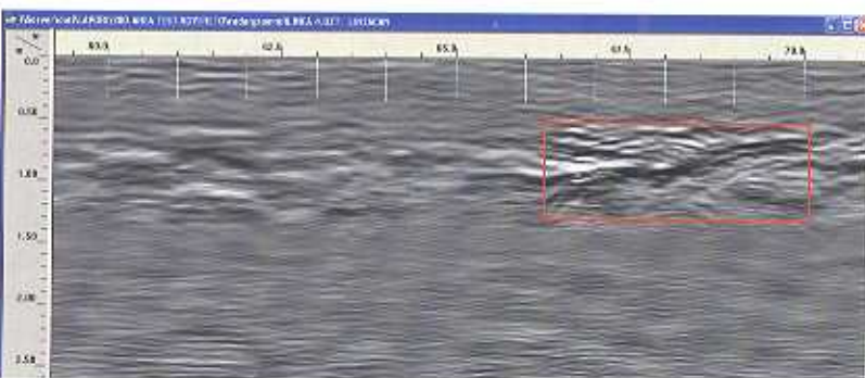
Fig. 32 - Radargramma di dettaglio della linea 4 relativo all'anomalia generata dalla cavità riempita di polistirolo.
