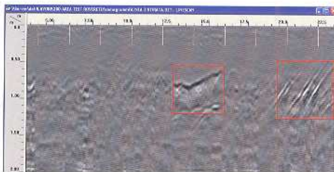
Fig. 34 - Radargramma di dettaglio della linea 3 con anomalie di cavità e di paleomorfologia sepolta.
