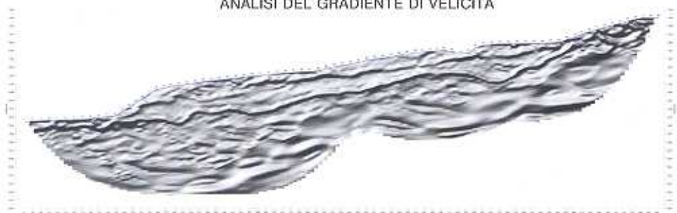
Fig. 21 - Esempio di sezione a grande scala in gradiente di velocità onde di compressione.
